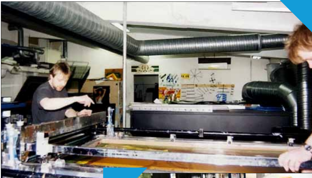
Kahdella miehellä väri kerrallaan, pientä säätöä ei voinut painamisen aikana välttää mitenkään. Seula muuten pestiin aina tinnerillä.
